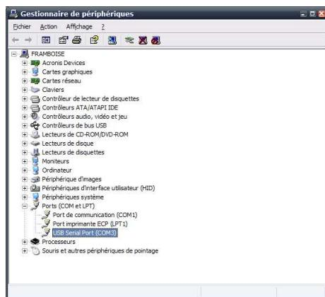
Cliquer sur « **Ports (COM et LPT)** » pour déplier l'affichage, vous devriez voir apparaître « **USB Serial Port (COMxxx)** » c'est ce numéro que vous devez utiliser avec les logiciels de prise de vue disponibles et compatibles avec notre interface. Par exemple « **COM3** ».
