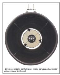
Les COLLIMATEURS LASERS sont très bien adaptés pour accomplir la deuxième étape soit d'aligner le centre optique du miroir secondaire sur le centre optique du miroir primaire. Lorsqu'on insère le laser dans le tube 1.25" du porte oculaire, la laser envoi son rayon sur le miroir secondaire qui lui, le réfléchi sur le miroir primaire. On remarque très souvent que le point réfléchi du laser sur le primaire arrive offset. Plusieurs facteurs expliquent ce qui peut se produire.
