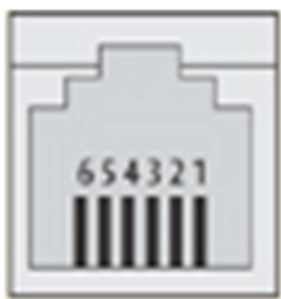
(Connecteur femelle sur le boîtier vu de face)
