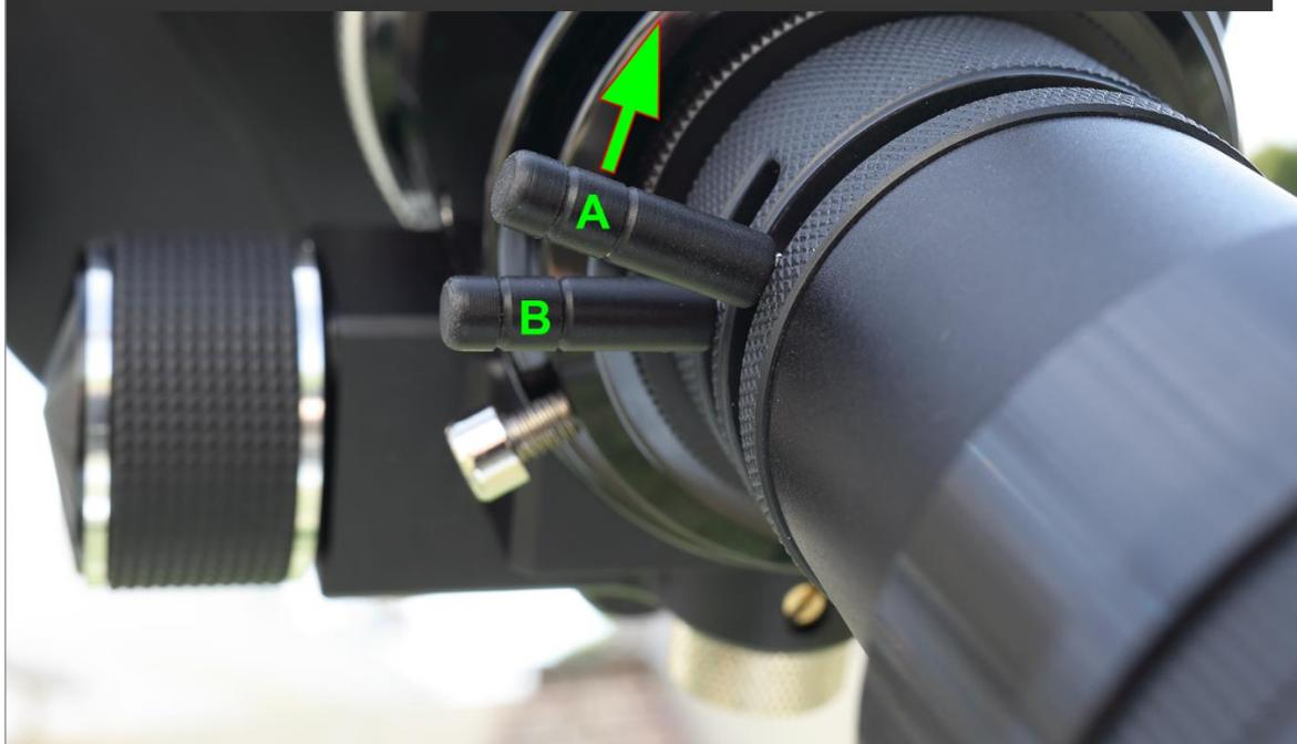
Après le réglage du levier A, faite en de même avec le levier B dans le sens de la flèche pour approcher le rond du centre
