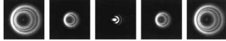
IMAGES D'ÉTOILES NON MISES AU POINT DANS UN TÉLESCOPE NECESSITANT UNE COLLIMATION
